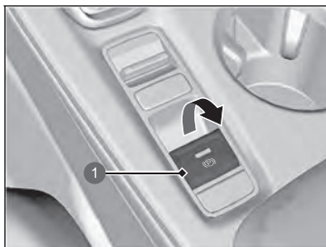
1 Interruttore del freno di stazionamento elettrico
